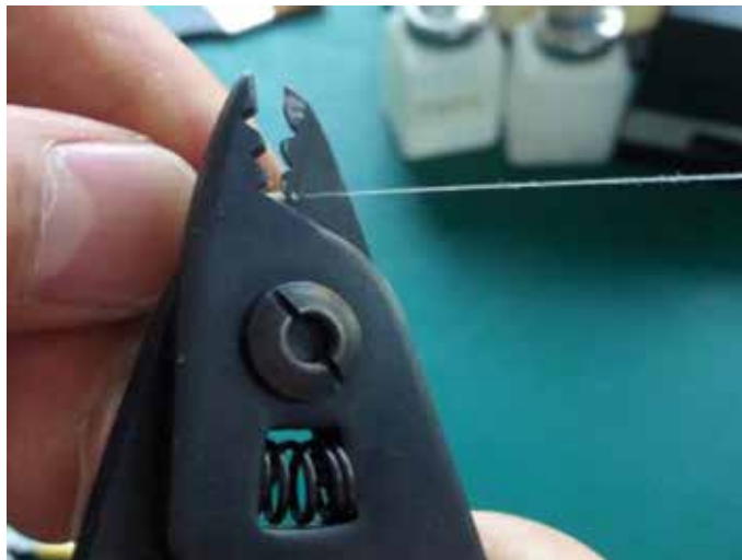
Fig. 3.5.3.2 Pele el revestimiento manualmente
