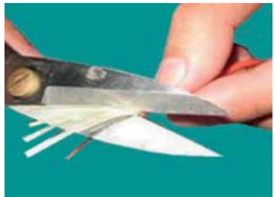
2. Corta los hilos de kevlar con las tijeras para ello
