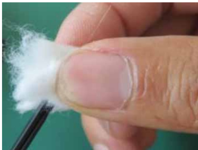
Fig. 3.5.3.3 Limpieza de la fibra
